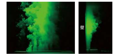
暖房時 (吹出温度 32℃/室内温度 22℃)
