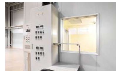
環境試験室 制気口の結露性能および材料の高湿多湿環境を測定します。
