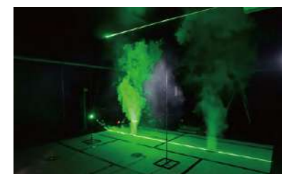
第3気流試験施設 壁からの輻射による室内温調設備を導入し、より精度の高い試験を実現します。
