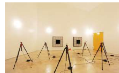
残響室 300m 3 の大容量から暗騒音10dB以下を実現します。
