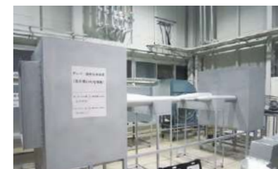
漏煙試験施設 ダンパー閉鎖時の気密性能を測定します。
