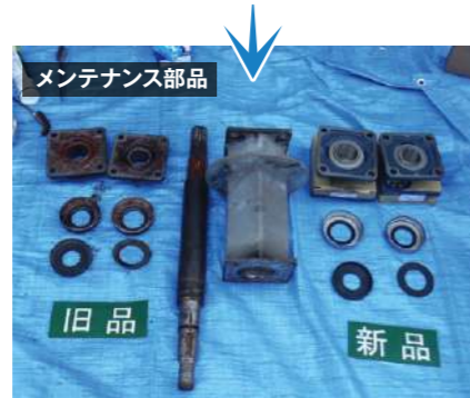
メンテナンス部品 ベアリング・オイルシール交換と分解整備を行います。劣化が進んでいる場合は、新品と交換します。
