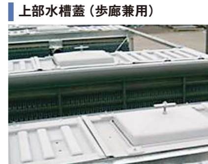
上部水槽蓋(歩廊兼用) 異物の混入を防ぎます。また遮光性も兼ねるのでスライムの発生を抑制します。歩廊兼用のため、塔上作業が安全に行えます。FRPまたは鋼板製。
