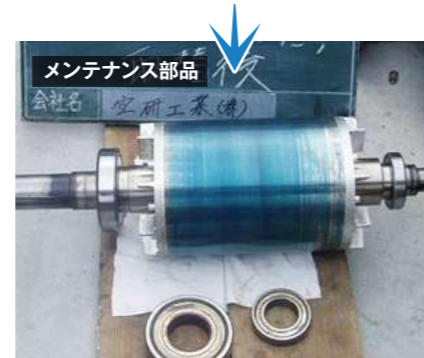
メンテナンス部品 ベアリングの交換と分解整備を行います。劣化が進んでいる場合は、新品と交換します。
